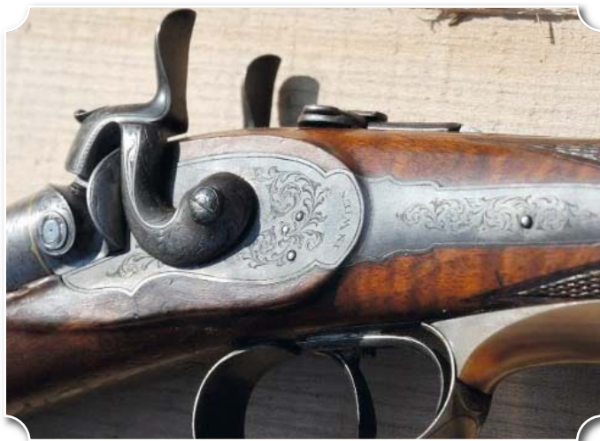
Илл. 3. Дульнозарядный штуцер 20-го калибра с ударно-капсюльными замками работы Антона Муляца, вторая половина 1860-х годов. На боковых досках выгравировано - ANT. MULACZ IN WIEN
