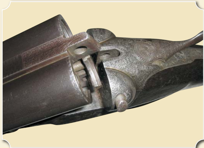
Илл. 1. «Франкотт» для дома ANT. MULACZ, № 33904, время производства - 1900 г. Замки «Энсон и Дили» с нижними шепталами, курки без отбоя, запирающие стволы тройное, предохранитель неавтоматический
