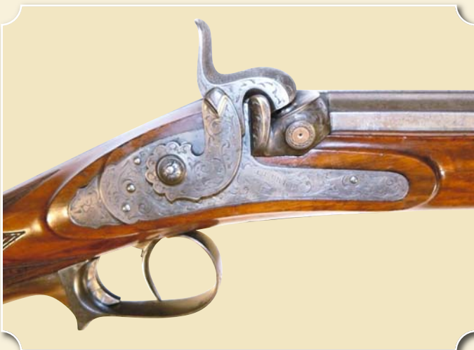
Илл. 2. Дульнозарядное гладкоствольное ружьё 16-го калибра с ударно-капсюльным замком. Изготовитель Карл Пирко, около 1850 года. На боковых досках и стволе выгравировано – С. PIRKO IN WIEN
