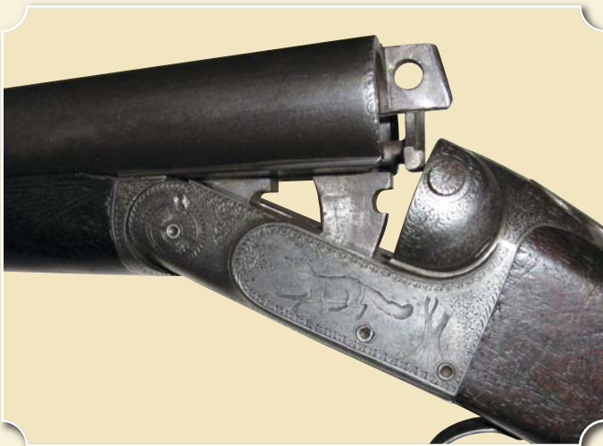
Илл. 1. «Франкотт» для дома ANT. MULACZ, № 33904, время производства - 1900 г. Замки «Энсон и Дили» с нижними шепталами, курки без отбоя, запирающие стволы тройное, предохранитель неавтоматический
